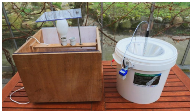
Skinnerval met kwikdamplamp (links) en LedEmmer met strip ledlampjes (rechts) (foto Eef Arnolds).
